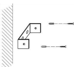
2. Fije la base de sujeción en la pared usando pijas o pijas con taquetes.
