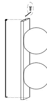
2. Ubique el área donde va a instalar el luminario y haga un orificio para el cable de alimentación. Fije la base de sujeción.
