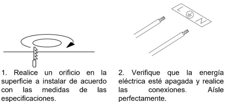
1. Realice un orificio en la superficie a instalar de acuerdo con las medidas de las especificaciones.
