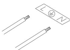
2. Verifique que la energía eléctrica esté apagada y realice las conexiones. Aíse perfectamente.
