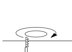
1. Realice un orificio en la superficie a instalar de acuerdo con las medidas de las especificaciones.
