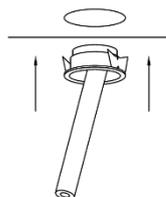
3. Inserte el luminario en el orificio asegurándolo con los soportes laterales.
