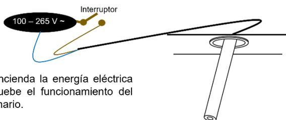
4. Encienda la energía eléctrica y pruebe el funcionamiento del luminario.
