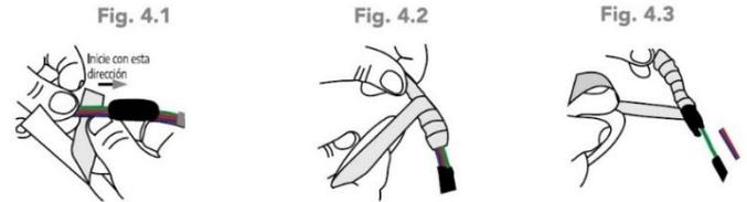
5.- Recubra todo aislamiento con la cinta vinil del cable de alimentación en dirección al cable de la luminaria.
