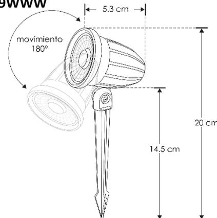
Este producto es usado como elemento de iluminación en piso para, jardines, muros, columnas y áreas exteriores. Incluye estaca.
