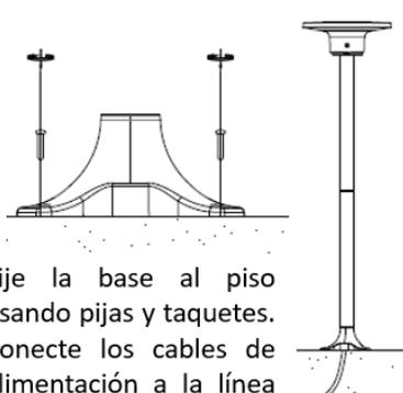
Fije la base al piso usando pijas y taquetes. Conecte los cables de alimentación a la línea eléctrica.
