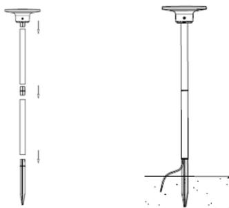
Arme el luminario colocando la estaca en la parte inferior y entiérrela en el suelo.
