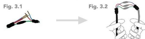
4.- Realice el aislamiento cubriendo la cinta vulcanizable desde el conductor de alimentación en dirección del cable de la luminaria.
