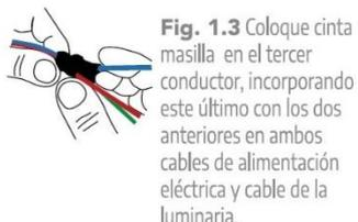
**Fig. 1.3** Coloque cinta masilla en el tercer conductor, incorporando este último con los dos anteriores en ambos cables de alimentación eléctrica y cable de la luminaria.
