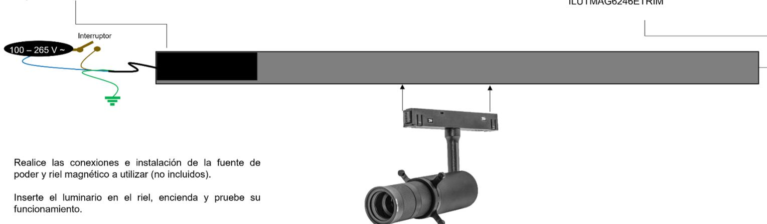
Realice las conexiones e instalación de la fuente de poder y riel magnético a utilizar (no incluidos).
