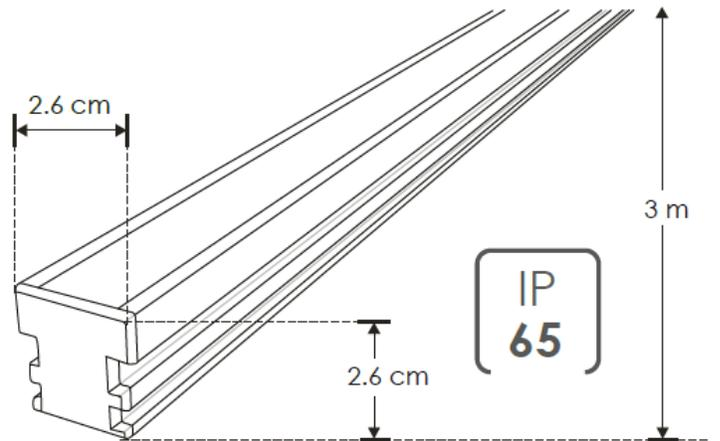
Utilizado para fabricar luminarios de LEDs con tiras extraplanas de 12/24V cc, para uso en interiores. Se recomienda usar tira de LED IP66 para exteriores.
