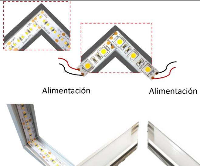
Para instalar tira de LED en una intersección de dos líneas luminosas haga el corte del perfil a la medida deseada y una las líneas.
