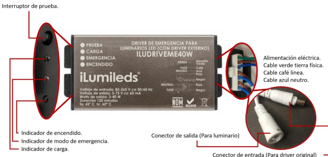
Con el siguiente diagrama de conexión, el luminario encenderá y apagará normalmente con el controlador (driver) original del luminario mientras haya energía eléctrica. Cuando la energía eléctrica falle, el luminario se mantendrá encendido sin importar la posición del interruptor.
