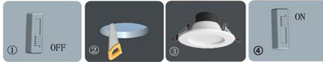
1. Desconecte la energía eléctrica antes de instalar el luminario.
