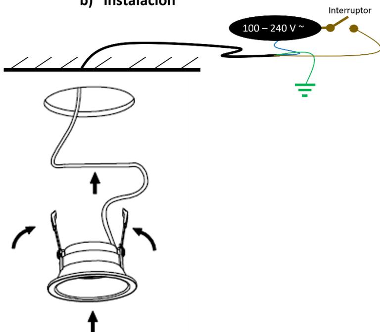
1. Realice un orificio en el techo de las dimensiones indicada en las especificaciones del luminario.
