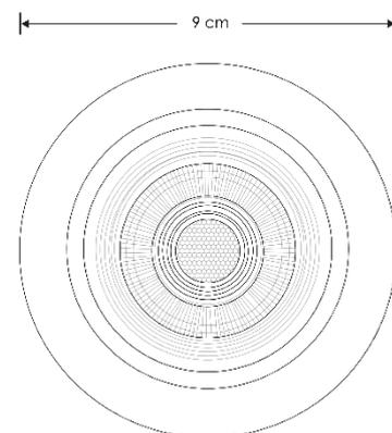
Luminario redondo dirigible de empotrar en techo con controlador (Driver) multi voltaje integrado y con posibilidad de seleccionar la temperatura de color deseada mediante interruptor.
