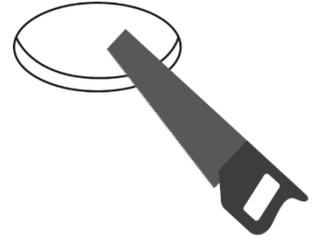
3. Haga un orificio de 7.2cm en la superficie donde va a instalar el luminario.
