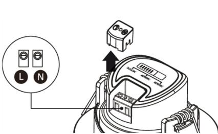
4. Haga las conexiones a la línea eléctrica y coloque la tapa en los bornes de alimentación.
