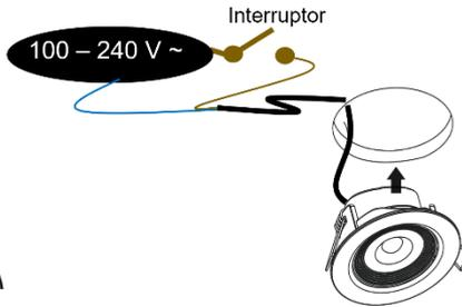
5. Inserte el luminario en el orificio asegurándolo con los soportes laterales.
