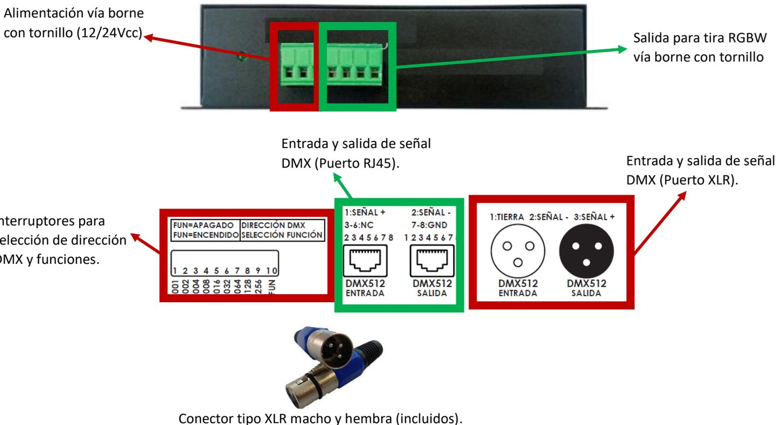
2. Arme el arnés para señal DMX usando los conectores tipo XLR y cable **BELDENCAT5301FE (no incluido)**. Dependiendo del puerto que vaya a utilizarse, puede armar el cable RJ45-XLR macho o XLR macho-XLR hembra (solo es necesario usar uno de los puertos de entrada DMX del controlador).
