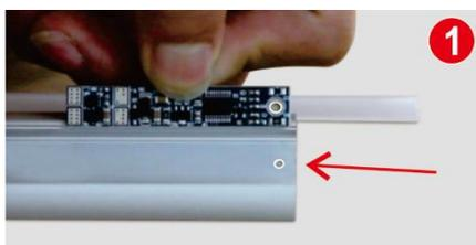
1. Realice un orificio en el perfil de aluminio que coincida con el orificio del sensor.
