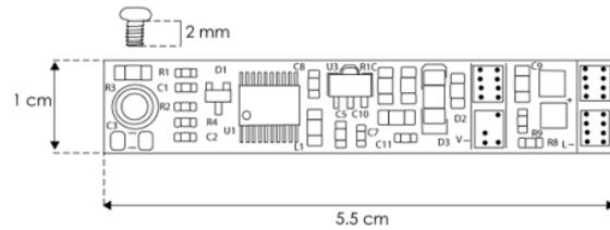
Utilizado como atenuador de intensidad de luz (dimmer) con función de apagado y encendido de tiras extraplanas del tipo monocromático con conexión a perfil de aluminio.
