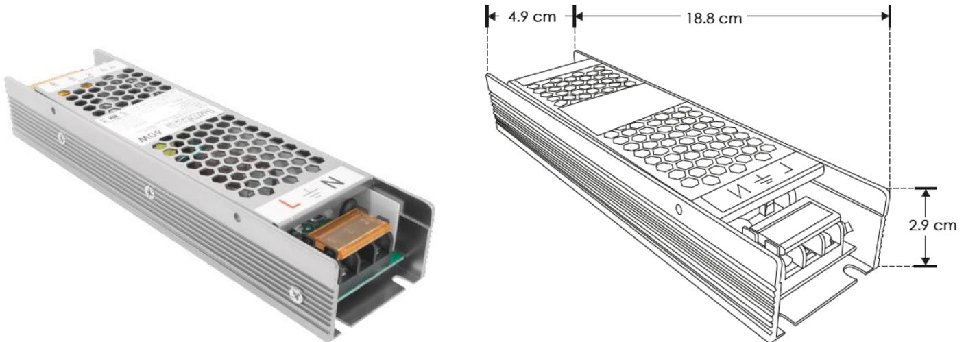
Fuente de poder atenuable para tiras extraplanas de LEDs, voltaje constante 24 V  $\text{---}$  compatible con 5 modos de atenuación: TRIAC, 0-10V, 1-10V, PWM y Potenciómetro.
