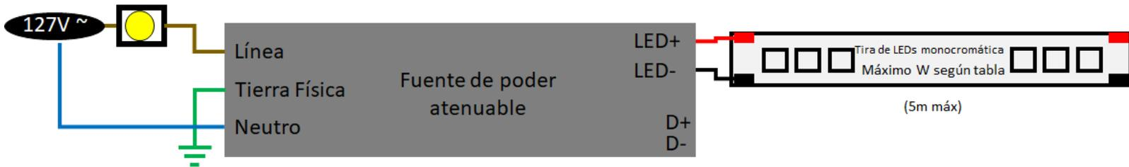
Diagrama para atenuador (Dimmer) tipo 0-10V o 1-10V:
