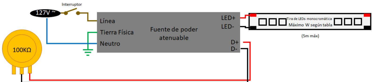
Diagrama para atenuador (Dimmer) tipo PWM:
