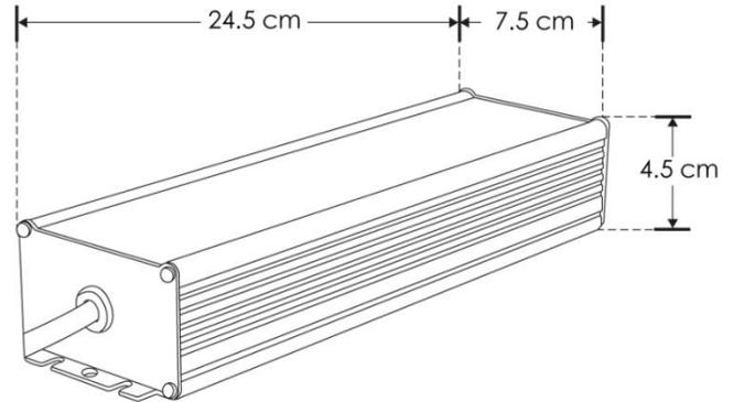
Fuente de poder atenuable para riel magnético o mini riel magnético, voltaje constante 48 V  $\text{DC}$ , compatible con 5 modos de atenuación: TRIAC, 0-10V, 1-10V, PWM y Potenciómetro.
