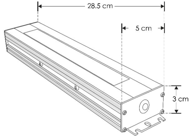
Fuente de poder atenuable para tiras de LEDs extraplanas con voltaje constante de 24 V  $\overline{=}$  compatible con 5 modos de atenuación: TRIAC, 0-10V, 1-10V, PWM y Potenciómetro.
