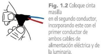
**Fig. 1.2** Coloque cinta masilla en el segundo conductor, incorporando este con el primer conductor de ambos cables de alimentación eléctrica y de la luminaria.
