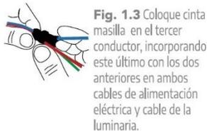
**Fig. 1.3** Coloque cinta masilla en el tercer conductor, incorporando este último con los dos anteriores en ambos cables de alimentación eléctrica y cable de la luminaria.
