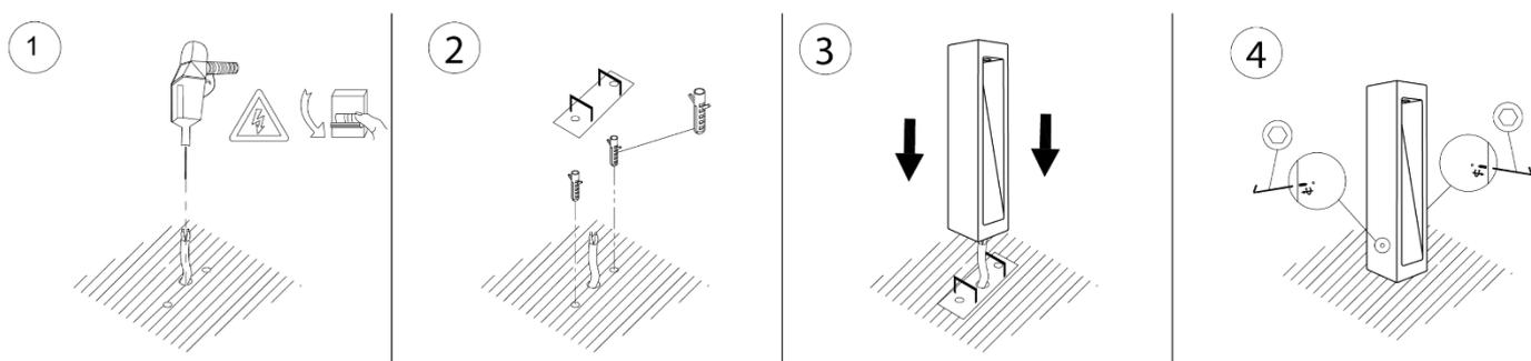
1. Apague la energía eléctrica y pase el cable de alimentación hasta el luminario.
