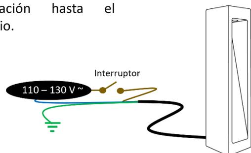
Encienda la energía eléctrica y pruebe el funcionamiento del luminario.
