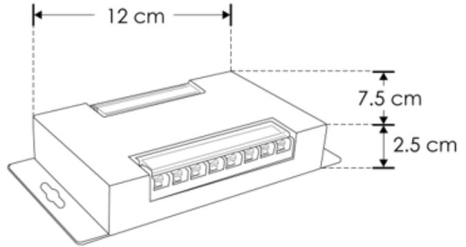
Utilizado para amplificar señal en tiras de led extraplanas del tipo RGBW cuando es necesario conectar más de 5 m y repetir el mismo efecto con un controlador manual o inalámbrico.
