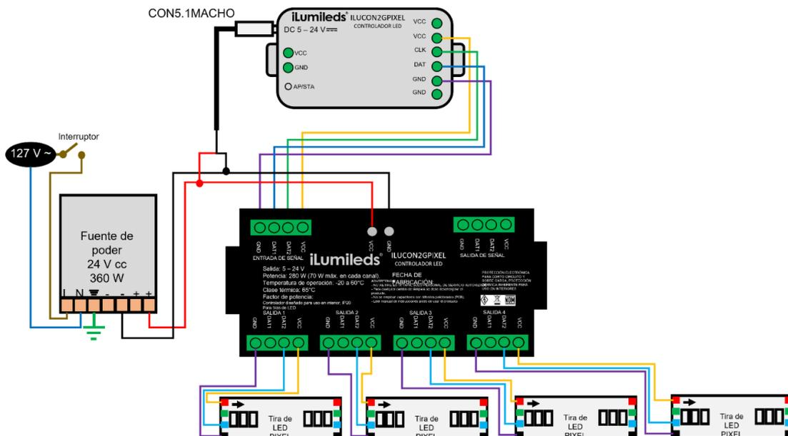
Importante: Para tener un efecto de corrimiento continuo, corte y una físicamente (separadas eléctricamente en máximos de 5M) tramos de tira de LED solo en múltiplos de 50cm (No conecte más de 5m de tira de LED en línea).
