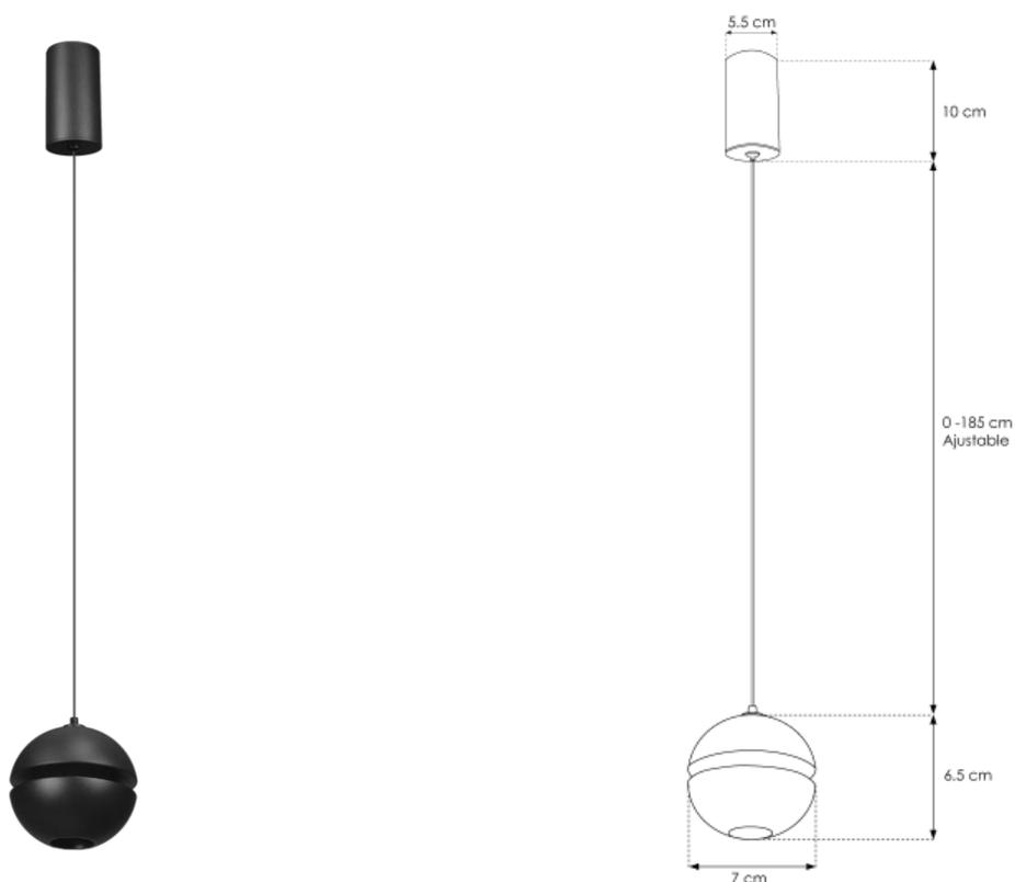
Luminario de LED con un cuerpo esférico, suspendido para sobreponer en techo.
