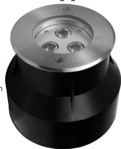
Este producto es usado como elemento de iluminación en albercas y fuentes. Tiene 3 LEDs de 3 W en blanco cálido. Requiere de una fuente de alimentación externa de 24 V  $\text{DC}$  modelo FP30W24EXT NO INCLUIDA.
