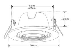
Este producto es usado como difusor de lámparas tipo MR16, GU10 o módulos de LEDs cuyo diámetro sea igual a 5 cm, dirigible, aluminio blanco mate. Uso en interiores IP20. Incluye conector GU10. Características técnicas: 127 V ~, 50/60 Hz, 35 W máximo (0.27 A).
