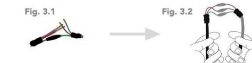
4.- Realice el aislamiento cubriendo la cinta vulcanizable desde el conductor de alimentación en dirección del cable de la luminaria.
