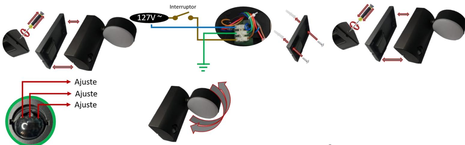
Para ajustar el luminario de acuerdo con el funcionamiento deseado, gire las perillas usando un desarmador plano.
