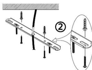
Fije la base de sujeción al techo y pase los cables de alimentación por el orificio central.
