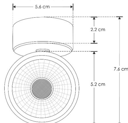
Este producto es usado como elemento de iluminación general en plafones y techos. Compatible con lámparas GU10 de hasta 35W. Lámpara no incluida. Incluye base GU10.
