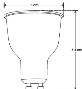
Lámpara tipo dicróico con base GU10 y ángulo de 38°, atenuable (Compatible con dimmers tipo TRIAC).
