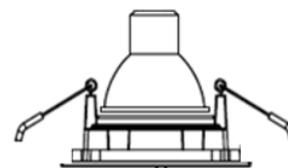
3. Coloque la lámpara en el difusor a utilizar (verifique la compatibilidad). Encienda la energía eléctrica y pruebe el funcionamiento.
