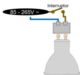
2. Inserte el la lámpara en la base GU10 (No incluida). Encienda y pruebe su funcionamiento.
