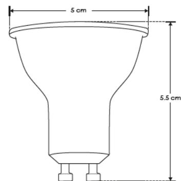
Lámpara tipo dicróico con base GU10 y ángulo de 38°, atenuable (Compatible con dimmers tipo TRIAC).
