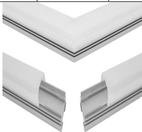
Para evitar sombras en una intersección de dos perfiles de aluminio, puede hacer un saque en la pared interior del perfil y colocar la tira de LED continua. Siempre haga que las micas de los dos perfiles queden perfectamente unidas para que no haya puntos de sombra y/o fugas de luz. Si es necesario aplique silicón semitransparente en las uniones de las micas para asegurar que no haya fugas de luz.
