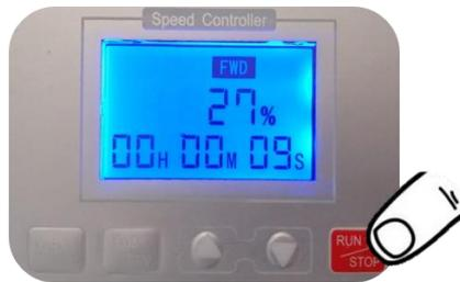
Al presionar la tecla de arranque, aparecerá una pantalla similar a esta, en la que aparece la velocidad y el sentido en el que giran los rodillos: FWD: Giro en sentido de las manecillas del reloj.
