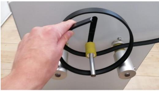
1. Haga el ángulo inicial de 18cm con la manivela y el rodillo de apoyo en su posición más baja. Hasta completar una vuelta y media.
