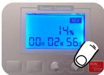
Con la tecla BAJAR puede disminuir la velocidad de rotación de los rodillos hasta un mínimo de 14%
