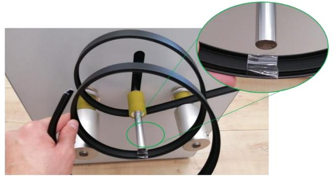
3. Moldee una vuelta completa, utilice cinta adhesiva para marcar el inicio de la curva.
