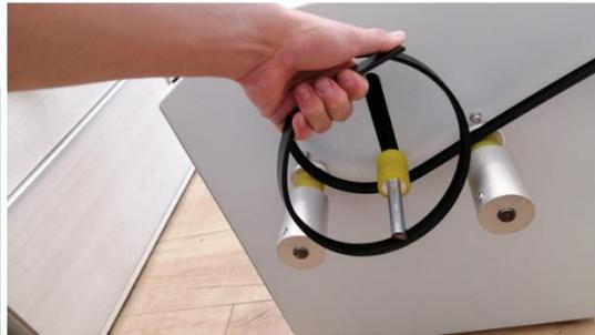
2. Para formar un espiral con círculos de 18cm, mantenga la misma posición del rodillo de apoyo y saque el extremo para moldear la figura continua.
