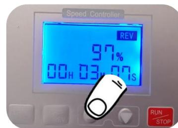
Con la tecla SUBIR puede aumentar la velocidad de rotación de los rodillos hasta un máximo de 97%
