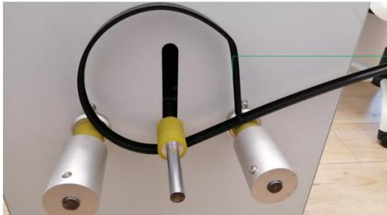
1. Con la manivela y el rodillo de apoyo en su posición más baja, se formará un arco o círculo de 18cm de diámetro.
