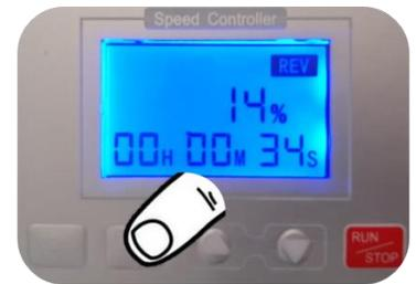
Al presionar la tecla DELANTE/REVERSA, se invierte el sentido de giro de los rodillos. REV: Giro en sentido contrario a las manecillas del reloj.
