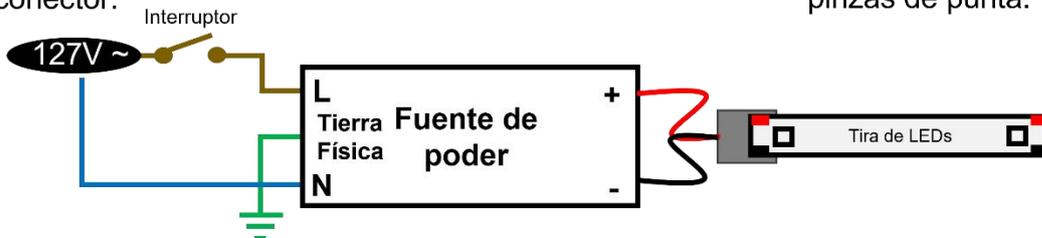
**El conector es IP20 (Para uso en interiores). Si requiere usarse con tiras de LED IP66 en exteriores, se debe cubrir la conexión con la tira usando termofit y silicón tipo DownCorning o similar**
