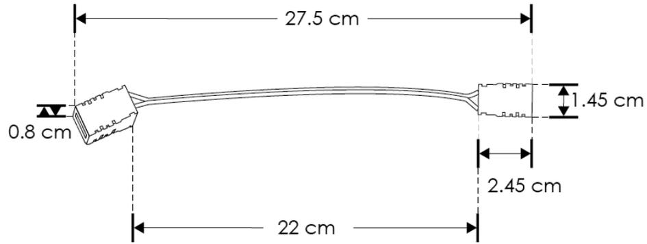
Conector rápido tipo caja de plástico de tercera generación para tira de LED extraplana con cable calibre 20. Utilizado para conectar tramos de tiras de LED sin soldadura.
