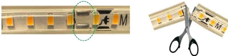
En caso de requerir unir dos tramos de tira, use el cople ACOPLTLC28355050 o el ACOPLTLF28355050 y silicón transparente (DOWN CORNING O SIKA) para evitar filtraciones de humedad. Al unir dos tramos de tira, observe que la dirección del dibujo de la clavija sea la misma en ambos tramos:
