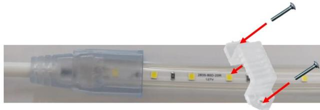
En caso de requerir unir dos tramos de tira, use el cople ACOPLTLC28355050 o el ACOPLTLF28355050 y silicón transparente (DOWN CORNING O SIKA) para evitar filtraciones de humedad. Al unir dos tramos de tira, observe que la dirección del dibujo de la clavija sea la misma en ambos tramos:
