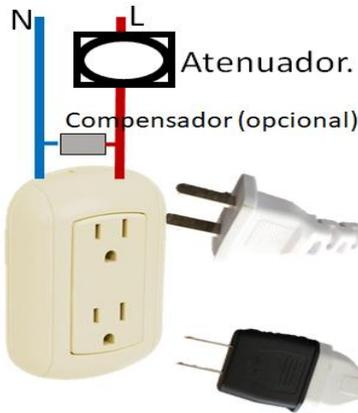
Si utilizará atenuador, asegúrese que sea tipo TRIAC de 127 V ~. En caso de que vea parpadeo o la tira no se apague completamente debido a las características del atenuador, coloque un compensador de carga.
