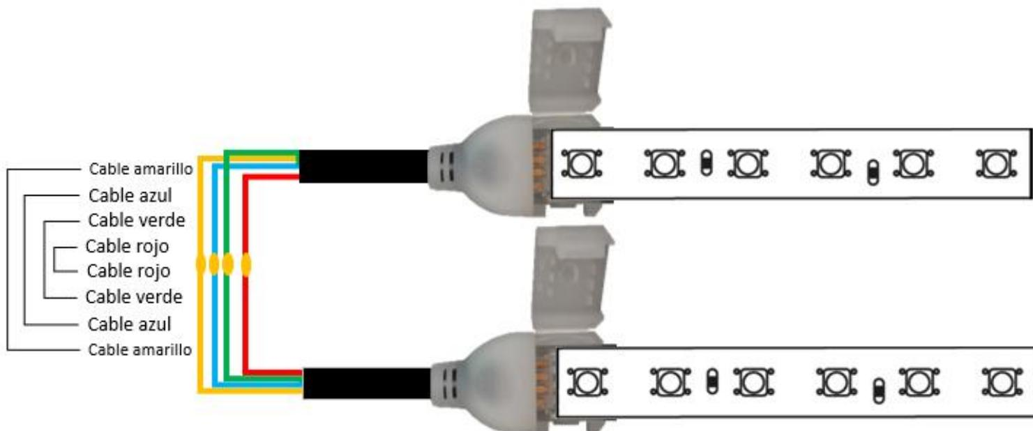
Conexión de dos cables con recubrimiento blanco:
