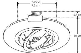
**NOTA:** Este producto es usado como difusor de lámparas tipo dicróica MR16, GU10 o módulo de LEDs. Incluye base GU10. Compatible con bote integral de 8.5 cm. No incluye lámpara.
