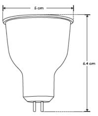
Lámpara tipo dicroico con base MR16 y ángulo de 38°, atenuable (Compatible con dimmers tipo TRIAC).
