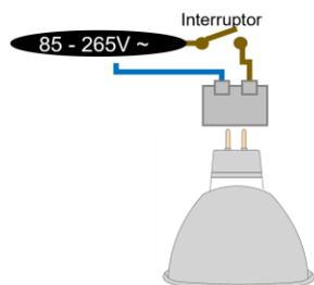
2. Inserte el la lámpara en la base MR16 (No incluida). Encienda y pruebe su funcionamiento.
