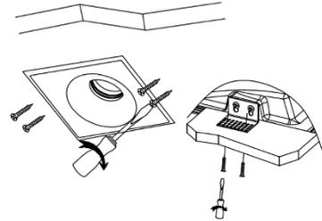
2. Coloque los soportes de acuerdo con la profundidad requerida por el material del recubrimiento final.
