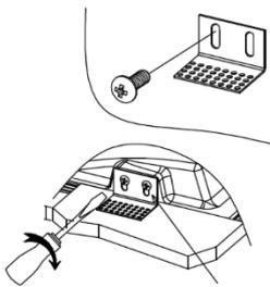
2. Coloque los soportes de acuerdo con la profundidad requerida por el material del recubrimiento final.
