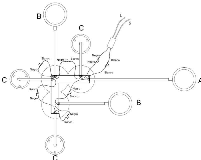
4. Finalmente conecte el controlador (driver) a los conectores indicados.
