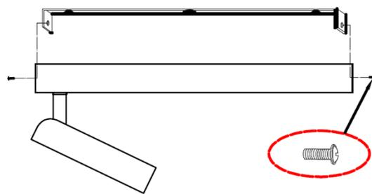
3. Fije el luminario a la base de sujeción con los tornillos laterales pasando los cables de alimentación
