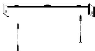
1. Fije la base de sujeción a la superficie donde va a instalar el luminario
