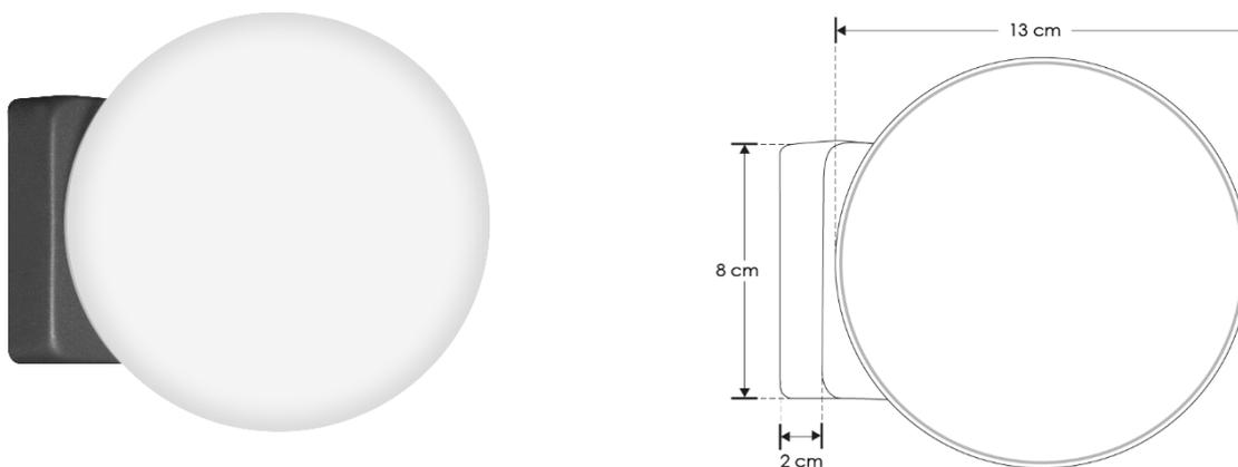
Este producto es usado como elemento de iluminación en muros, de uso en interiores.
