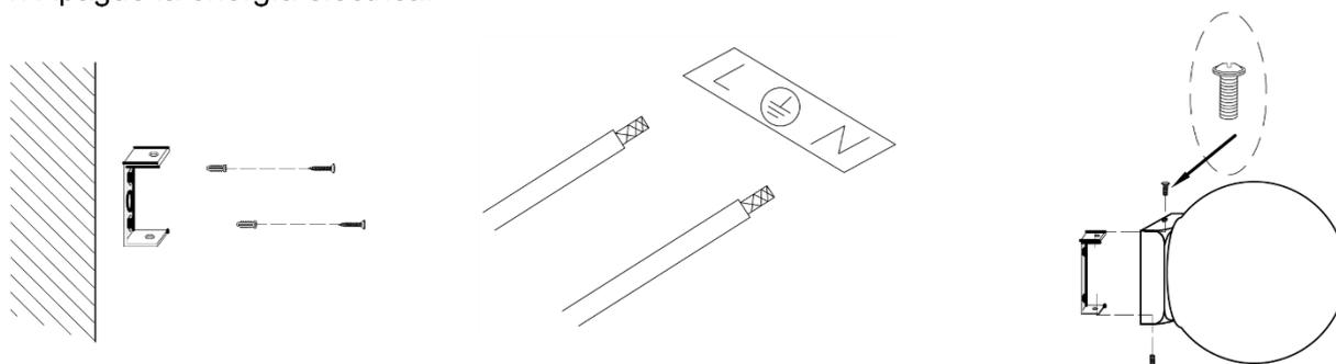
2. Ubique el área donde va a instalar el luminario y haga un orificio para el cable de alimentación. Fije la base de sujeción.
